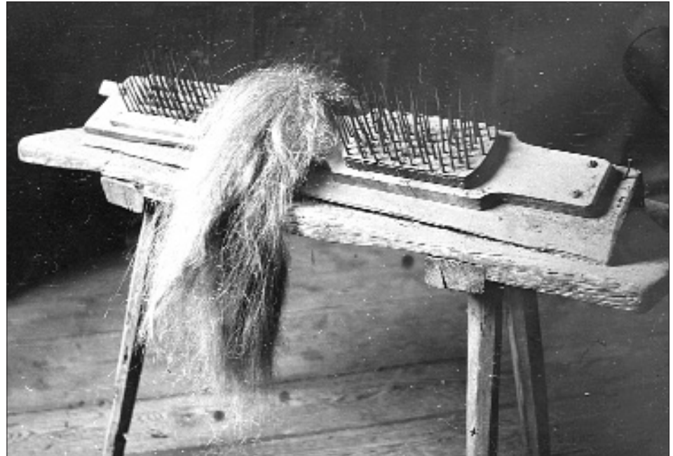
„Hachl“, 1965. – An diesem Gerät konnten zwei Frauen arbeiten; sie standen sich gegenüber. Alle Fotos: Hans Kurzthaler, Thurn
