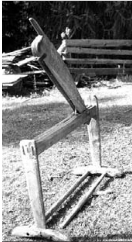
„Brechl“, 1956. – Damit trennte man die Verholzung von der Faser.
